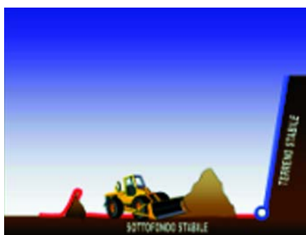
1. posizionamento del cassero, della griglia, del drenaggio e compattazione di una porzione di terreno per bloccare cassero e griglia.
