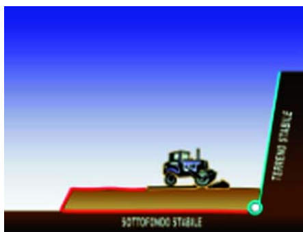
2-3. realizzazione e compattazione del primo strato e risvolto della griglia.
