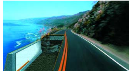
Es. 1 drenaggio dietro a muro di sostegno
